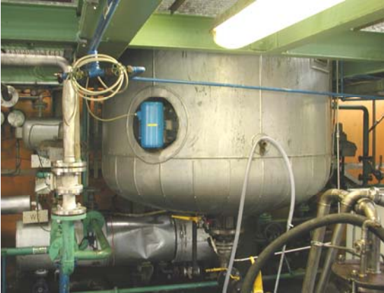
Schallsensor in einem Polymerisations – Reaktor Schallsensor und Refraktometer in einer Rohrleitung
