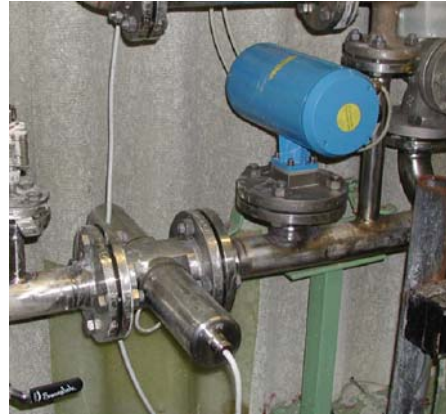
Schallsensor in einem Polymerisations – Reaktor Schallsensor und Refraktometer in einer Rohrleitung
